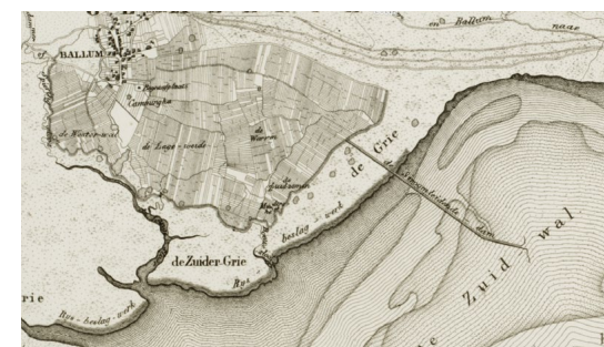
Om de afkalving van de waddenkust van Ameland tegen te gaan werd in 1847 deze 1200 meter lange stroomgeleidingsdam in de Ballumerbocht aangelegd (Topografische Kaart 1855).
