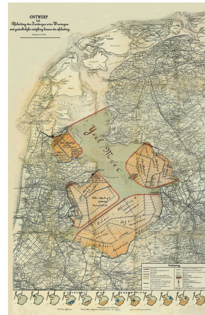
Het ontwerp van Cornelis Lely uit 1891 voor de afsluiting en gedeeltelijke inpoldering van de Zuiderzee (Stichting Rijksmuseum het Zuiderzeemuseum). De Zuiderzeewerken zijn op hoofdlijnen volgens dit plan uitgevoerd, al zijn er in de loop van de tijd ook de nodige aanpassingen geweest. Zo moest voor een iets ander tracé van de Afsluitdijk worden gekozen. Met de afsluiting van de Zuiderzee in 1932 veranderde ook de dynamiek in het Waddengebied.
